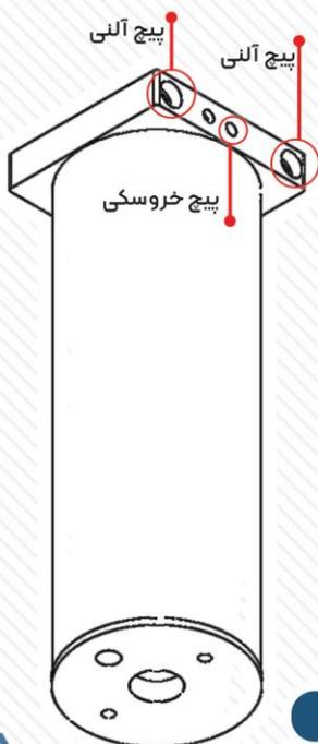
ابتدا پیچ خروسی ( تصویر ) موجود در دستگاه را مطابق تصویر رو به رو کپسول وصل کرده و با کمک آن کپسول را در مسیر میل راهنماهای داخل دستگاه قرار داده و به صورت کشویی تا انتها به داخل فشار دهید تا LED سبز رنگ موجود روی کپسول روشن شود
