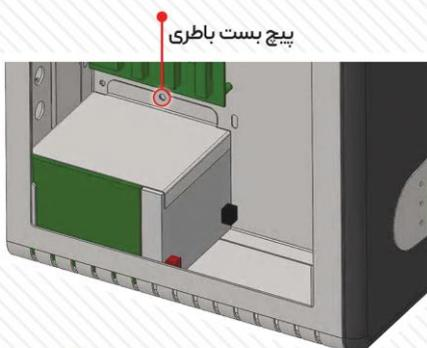
باطری مناسب برای نصب در دستگاه باید 12 ولت 4.5 یا 5 آمپر ساعت باشد و برای نصب آن ابتدا بایستی پیچ مربوط به بست نگهدارنده باطری را باز کرده و بعد از قرار دادن باطری در محل خود طبق عکس بست مربوطه را مجدد ببندید
